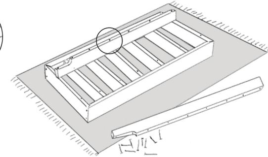
**7** Plaquer le meuble monté contre le mur, Vérifier la verticalité **et** l'horizontalité, Marquer les trous à percer (deux par montants verticaux arrières), Percer le mur, Positionner les chevilles dans le mur (ou équivalent)
